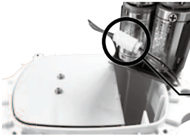
電池ホルダーコネクタ (写真は接続されている状態)
