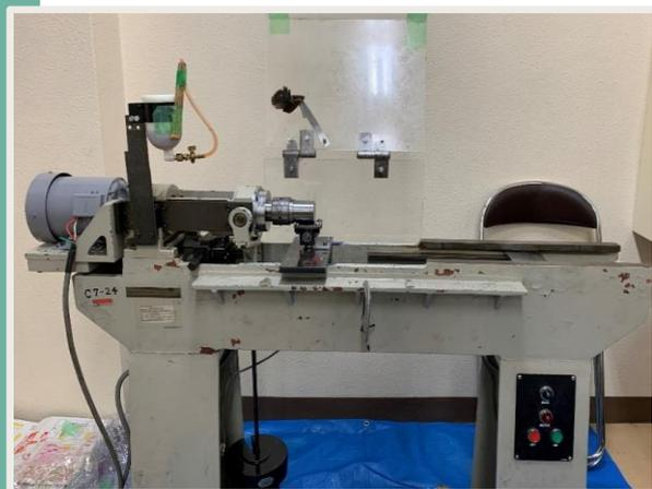
■ 回転曲げ試験機を利用した摩擦摩耗試験機
