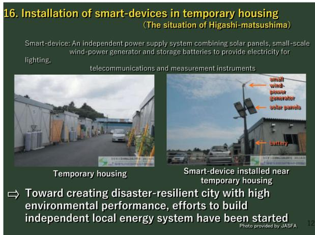
図1 仮設住宅の自立電源照明システム
