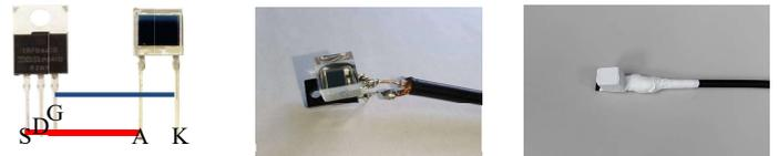
フォトダイオードのアノードとFETのソース、カソードとゲートを接合する。ドレインを同軸ケーブルの芯線と、ソースを外側の銅線を接合する。CsIシンチレータは温度による潮解性を有しているため、シールテープを巻きつけている。さらにその上から遮光するためにアルミテープを巻く。
