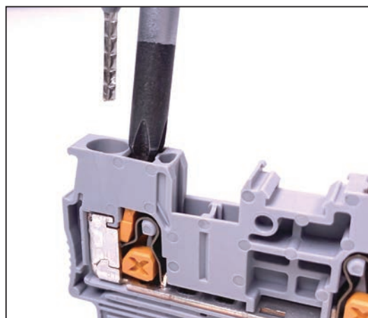
4. リリース 専用工具不要でプラスドライバーでも作業可能
