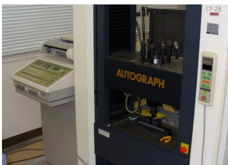
万能試験機(容量 5kN, 250kN)
